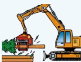
立木を切り倒すと同時に造材も行う高性能重機「ハーベスタ」
